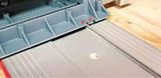
Perfekter Höhenausgleich. Durch den Gleiter aus Pertinax wird die Materialstärke der Führungsschiene ausgeglichen.
