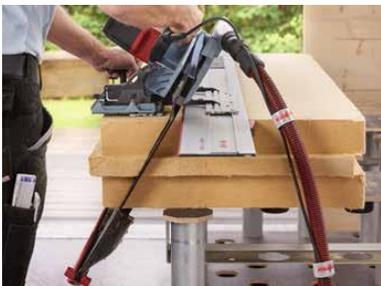
**MAFELL Dämmstoff-Seilsäge DSS 300 cc-Neigungsschnitt.jpg**
