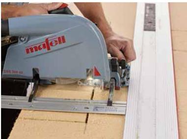
**MAFELL Dämmstoff-Seilsäge DSS 300 cc-Fensterausschnitt.jpg**
