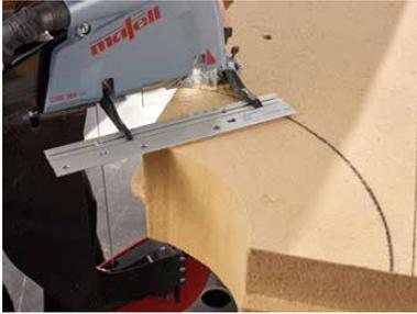
**MAFELL Dämmstoff-Seilsäge DSS 300 cc-Kreissegment.jpg**
