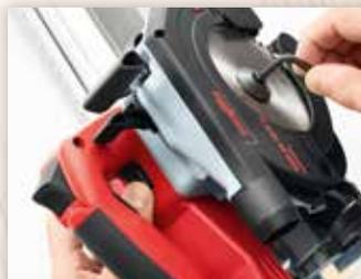
Die Sägeblattparkierung kann zum Sägeblattwechsel einfach per Knopfdruck betätigt werden. Das Sägeblatt wird dann mit dem am Gerät befestigten Sechskantschlüssel einfach und schnell ausgetauscht.
