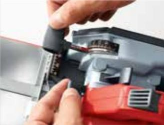
Die Schnitttiefe lässt sich schnell und stufenlos anpassen. Nach dem Lösen der Klemmung wird die Tiefe via Skala eingestellt.
