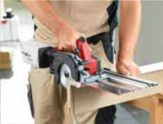
Mit einer Schnitttiefe von bis zu 42 mm deckt die neue KSS 40 18M bl bis zu 80 Prozent der Anwendungsfälle auf Baustellen ab und sorgt für einen sauberen Schnitt – mit gewohnt hoher MAFELL Performance.
