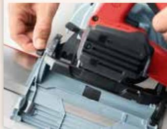
Der Schwenkpunkt der KSS 40 18M bl befindet sich seitlich an der Unterkante der Schiene. So gibt es nur einen Risszeiger – egal ob in Winkel-einstellung, ob mit oder ohne Schiene.
