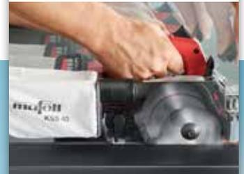
Mit der Säulen-Höhenführung können Tauchschnitte einfach und präzise durchgeführt werden. Der gefederte FLIPPKEIL ermöglicht dabei auch ohne Abschrauben des Spaltkeils ein sicheres Arbeiten.
