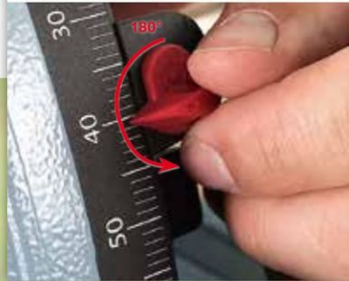
Die Schnitttiefe kann millimetergenau justiert werden. Mit oder ohne Schiene - durch eine einfache Drehung zeigt der Schnitttiefenanzeiger immer die exakte Tiefe des Sägeblatts an.
