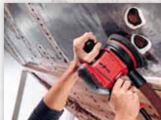
Für einen Grobschliff ist der EVA 150 E/5 die richtige Wahl. Hier sind die Voraussetzungen dank einem Schwinghub von 5 mm und 12.000 U/min optimal.
