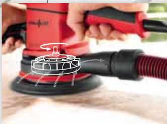
Die leistungsstarke Eigenabsaugung ermöglicht in Verbindung mit der Multi-Lochung des Schleiftellers ein staubarmes und sicheres Arbeiten. So setzt sich das Schleifmittel weniger zu, der Schleifmittelverbrauch sinkt, das Arbeitsergebnis wird verbessert.
