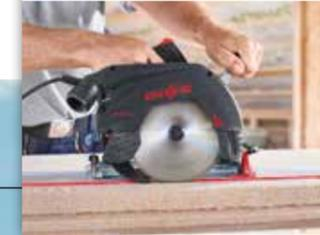
Der **FLIPPKEIL** ermöglicht – auch ohne Abschauben des Spaltkeils – einen **sicheren, bequemen und einfachen Tauchschnitt**.
