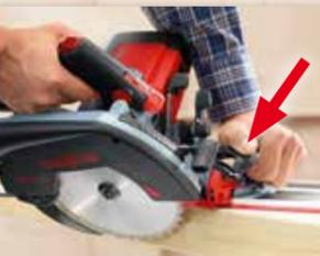
Per Voreinzug lässt sich die Pendelhaube bequem und einfach bedienen und sorgt bei Tauch- und Schrägschnitten für Komfort und Sicherheit.
