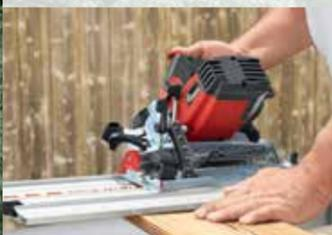
Dank großdimensionierter Winkelskala und präziser Doppelklemmung lassen sich Geührungsschnitte passgenau umsetzen. Wie hier am Beispiel einer Fassadenschalung.
