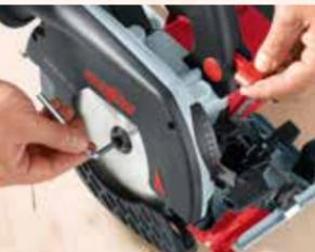
Durch Drücken des Akku-Entriegelungsknopfes wird die Stromzufuhr unterbrochen und das Sägeblatt automatisch arretiert. Anschließend kann das Sägeblatt mit dem am Gerät befestigten Sechskantschlüssel sicher und gefahrlos ausgetauscht werden.
