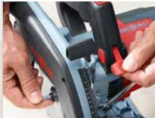
Zum Sägeblattwechsel wird das Sägeblatt der K 65 einfach per Knopfdruck arretiert und dabei automatisch die Einschaltperre aktiviert. Das Sägeblatt lässt sich dann mit dem am Gerät befestigten Sechskantschlüssel einfach und schnell austauschen.
