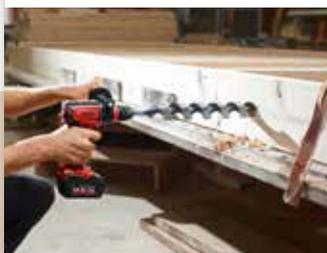
Sarà un gioco da ragazzi eseguire fori nel legno con punta elicoidale fino a 50 mm di diametro con i trapani-avvitatori A18 M bl e ASB 18 M dotati di impugnatura supplementare.
