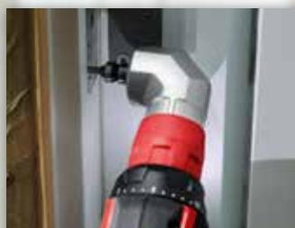
Usando il trapano-avvitatore A 10 M con l'angolare è possibile inserire le viti anche negli spazi più difficili.
