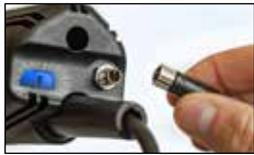
Duo-In: las revoluciones se pueden ajustar sin escalonamiento a cualquier aplicación, manualmente o mediante la interfaz del pórtico. Indicador de estado LED adicional.
