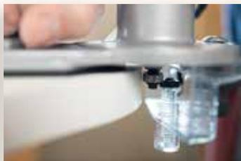
El freno del anillo de tope evita dejar marcas de mecanizado poco atractivas en materiales sensibles.
