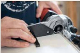
El tope insertable garantiza un guiado seguro en el mecanizado de esquinas.
