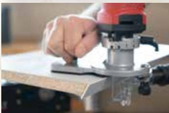
La gran superficie de apoyo permite mecanizar con total seguridad incluso cantos inclinados.
