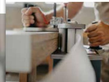
Si possono regolare senza gradini grandi altezze di bordo, fino a 65 mm o 103 mm, che si raggiungono a seconda dello spessore del pezzo.
