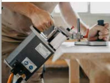
È possibile bordare superfici inclinate in poche manovre. Nelle applicazioni mobili si ottengono fino a 50°, mentre con la regolazione angolare pneumatica si raggiungono 55° sul piano di lavoro.
