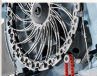
Il rullo di guida è dotato di due lati, uno per la lama e uno per l'azionamento. Inoltre i dispositivi rimuovitrucoli disposti sopra e sotto il rullo eliminano la polvere e garantiscono il libero movimento della lama a filo.
