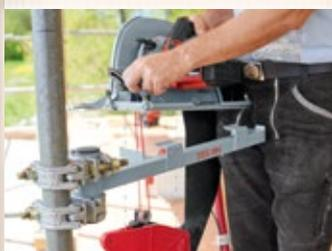
Grazie all'attacco S200-MH la DSS 300 cc potrà essere fissata all'aspiratore volumetrico oppure, con l'ausilio degli appositi giunti, direttamente al ponteggio per l'uso in cantiere.
