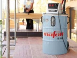
Durante la lavorazione di materiale isolante in fibra di legno viene prodotta una grande quantità di trucioli e polvere. L'aspiratore S 200 elimina il 90% del volume senza problemi.
