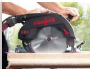
**Все просто:** Функция 2-в-1 помогает делать пропилы с погружением комфортно и просто. Кроме того, подпружиненная система погружения FLIPRKEIL позволяет делать безопасные пропилы с погружением, не снимая расклинивающий нож.
