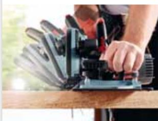
Превосходное качество пропила даже при пилении под углом: ручная циркулярная пила оптимизирована для использования с направляющей шиной. K 85 / K 85 Ec всегда пилит точно вдоль кромки резиновой антискользящей ленты.
