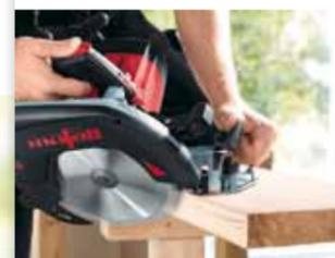
Вторая рукоятка позволяет удобно и просто убирать защитный кожух. Это делает установку пилы на заготовке при пропилах под углом еще более комфортной и безопасной.
