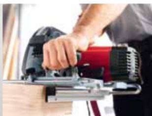
**Все просто:** Новый нижний упор позволяет и в непростых ситуациях добиваться высокой точности пропилов. Две шкалы на зажимах типа «бюгель» позволяют точно задать требуемые размеры.
