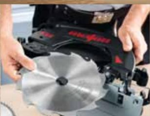
**Все просто:** Замена пильного диска у K 85 / K 85 Ec осуществляется быстро, безопасно и удобно. Просто нажмите на деблокирующую кнопку (1), приподнимите рычаг (2), заблокируйте в корпусе защитный кожух (3), ослабьте винт, выньте и замените пильный диск, зажмите его и вновь опустите рычаг (2).
