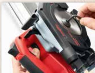
El bloqueo de la hoja de sierra se puede accionar fácilmente para cambiar la hoja con sólo pulsar un botón. La hoja de sierra se sustituye con rapidez y facilidad con la llave hexagonal que va fijada al aparato.
