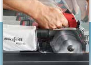
Con la guía de altura de columna se pueden realizar cortes de inmersión con facilidad y precisión. El FLIPPKEIL elástico permite trabajar de forma segura incluso sin desatornillar el cuchillo separador.
