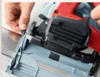
El centro de gravedad de la KSS 40 18M bl se encuentra lateralmente en el canto inferior de la guía. Así, existe un solo indicador de proyección, ya sea en ajuste angular, con o sin guía.
