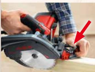
Нажатие на рычаг позволяет удобно и просто убирать защитный кожух. При выполнении пропилов с погружением и косых пропилов это обеспечивает комфорт и безопасность.
