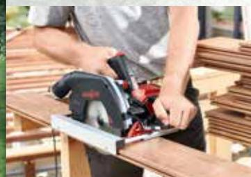
Направляющие линейки MAFELL или входящий в комплект поставки параллельный упор с миллиметровой шкалой помогают, к примеру, точно подгонять друг к другу доски пола на террасе.
