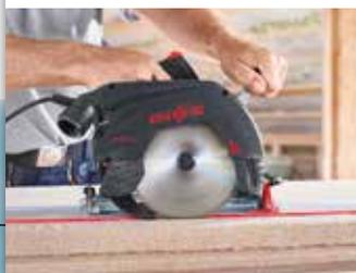
“Плавающий” раскливающий нож FLIPPKEIL позволяет безопасно, удобно и легко выполнять пропилы с погружением без необходимости демонтажа раскливающего ножа.
