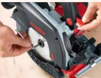
После нажатия на кнопку разблокирования аккумулятора прерывается подача электроснабжения, пильный диск автоматически блокируется. После этого можно безопасно заменить пильный диск при помощи расположенного на пиле ключа-шестигранника.
