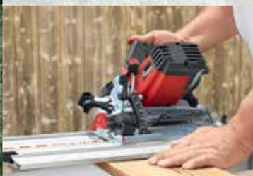
Большая шкала, на которой указаны углы наклона, и система двойного зажима пилы под требуемым углом позволяют максимально точно выполнять наклонные пропилы, как показано на фото, в ходе фасадных работ.
