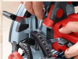
Модель К 65 сс позволяет устанавливать и фиксировать требуемую глубину пропила в диапазоне от 8 до 67 мм.
