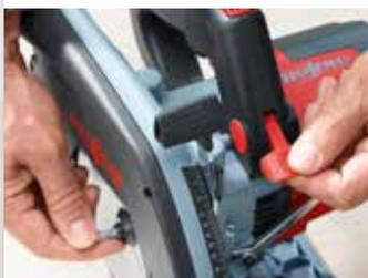
Для замены пильного диска пилы K 65 cc он просто блокируется нажатием на кнопку, при этом автоматически активируется защита от случайного включения. После этого пильный диск можно легко и быстро заменить при помощи расположенного на пиле ключа-шестигранника.
