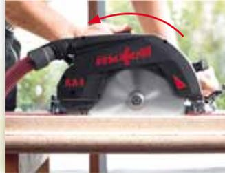
Die Spanführung der neuen Handkreissäge wurde so optimiert, dass der Absaugkanal selbst beim Schneiden von Holz-faserwerkstoffen nicht verstopfen kann: wichtig auch bei Eintauch-schnitten in Faserrichtung.
