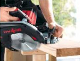
Die Pendelhaube lässt sich vom zweiten Handgriff bequem und einfach einziehen. Das macht das Ansetzen der Maschine speziell bei Schrägschnitten komfortabel und sicher.
