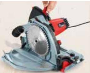
Per il cambio della lama più rapido al mondo: basta premere il tasto di sbloccaggio e sollevare la leva. Si apre il corpo macchina, ora è possibile cambiare la lama in pochi secondi. Con la copertura della lama alzata si attiva automaticamente la sicurezza di avviamento e il bloccalama.
