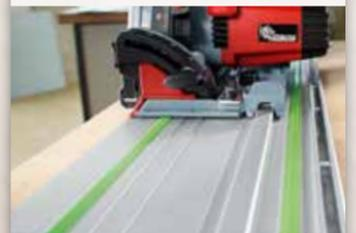
La guida delle barre è integrata nella base in magnesio pressofuso della MT 55 cc. Con la seconda scanalatura di guida presente nella base e le ganasce di guida regolabili la MT 55 cc potrà essere adattata perfettamente anche a sistemi di guide di altri produttori.
