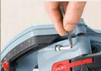
Per la regolazione micrometrica della profondità di taglio ad esempio utilizzando lame riaffilate oppure per materiali Fermacell.
