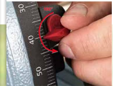
E' possibile regolare la profondità di taglio in modo rapido e preciso. Con o senza guida, l'indicatore della profondità di taglio mostra la posizione esatta della lama.
