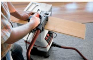
Il T-MAX fissato sul sistema di aspirazione può servire da piano d'appoggio per i piccoli pezzi da lavorare.
