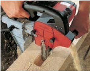
Zapfenlöcher mit dem LS 103 Ec in verschiedenen Abmessungen bis 100 mm.
