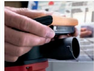
Die mechanische Klemmung für Rollenpapier spannt das Schleifpapier exakt und lässt das Papier nicht durchhängen.
