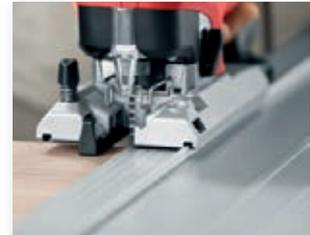
Für exakt gerade Schnitte lässt sich die P1 cc mit der MAFELL Führungsschiene F kombinieren.
