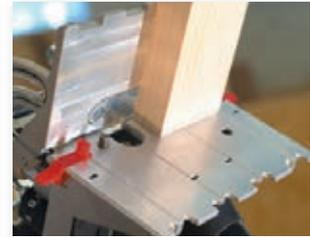
Mit den Zusatzanschlüssen lassen sich kleinere oder größere Randabstände schnell und präzise erzielen.
