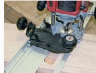
Das Treppenwangen-Fräsergerät im Sonderzubehör für Ausfräsungen von 640 x 60 mm.
