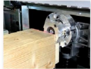
Ob gerade oder schräge Zapfen, die Steuerung ermöglicht eine 4-seitige Bearbeitung in einem Arbeitsgang. Damit sind alle Zapfen auch ringsum angefast.
