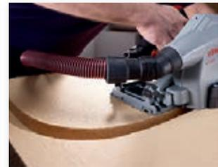
Versorgungsleitungen in Weichfaserplatten lassen sich mit dem Verstellnutter MF-VN 25 staubarm und schnell umsetzen.
