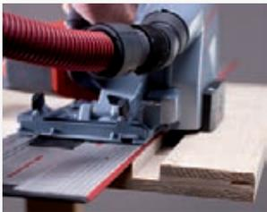
Mit dem Verstellnuter MF-VN 25 können Nuten für Stellbretter oder Versorgungsleitungen effektiv und schnell eingefräst werden.
