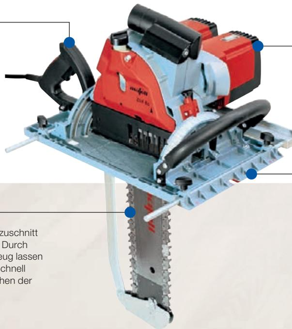
Herzstück der ZSX-TWIN Ec sind die beiden 3000-Watt-Lichtstrom-Motoren. Parallel werden sie an zwei 230 V Phasen aus dem Kraftstromnetz betrieben.
