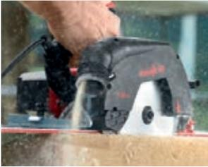
Die Spanführung der neuen Sägen wurde so optimiert, dass der Absaugkanal nicht verstopfen kann. Ein wichtiger Vorteil auch bei Tauchschnitten in Faserrichtung.
