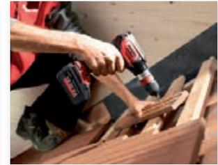
Der ASB 18 M bl vereint drei Akku-Geräte in einem: einen Schrauber, einen Bohrer und eine Schlagbohrmaschine.
