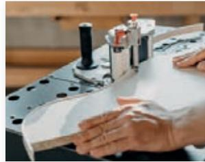
Individuelle und komplexe Freiformteile lassen sich ausgezeichnet mit dem HIT-M 65 SA inkl. angetriebener Transportrolle und dem Bearbeitungstisch BAT erstellen.
