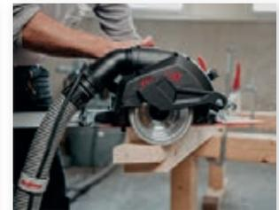
Einzelne Zapfen lassen sich mühelos mit der NFU 50 und der Führungseinrichtung L durchführen.
