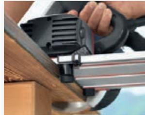
Der fixe und der einstellbare Anschlag an der Unterseite der Schiene sorgen dafür, dass das System für Winkelschnitte von +60° bis -60° eingesetzt werden kann.
