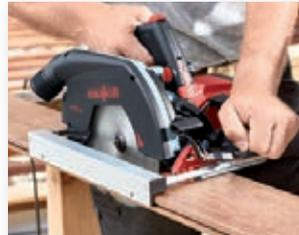
Mit den MAFELL Führungsschienen oder dem im Lieferumfang enthaltenen Parallelschlag mit Millimeter-Skala können beispielsweise Terrassendielen exakt eingepasst werden.
