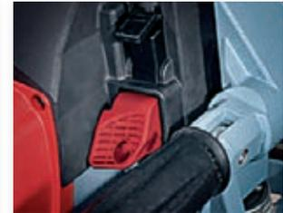
Die mechanische Sicherheitsbremse wird über die kombinierte Brems- und Ausschalt-Taste betätigt und sorgt ebenso für mehr Sicherheit wie der integrierte Spannungsabfallschalter.
