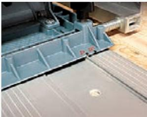
Für präzise, geführte Schnitte lässt sich die ZSX-TWIN Ec auf das bestehende MAFELL Führungsschienen-System F aufsetzen.
