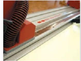
Über den MAFELL-Sauger S 50 M und den integrierten Absaugkanal werden Staubpartikel fast vollständig abgesaugt.
