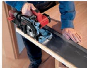
In Kombination mit der rollbaren Flexi-Schiene FX 140 sind präzise geführte Schnitte bis 1,4 m kein Problem.
