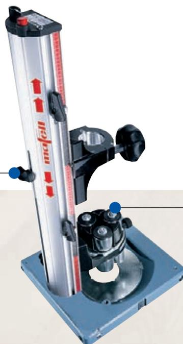
80 mm hohe Bohrerführung mit sechs vertikal gelagerten Rollen, die durch eine irisartige Einstellmechanik den Bohrer perfekt führen – damit wird das Verlaufen des Bohrers verhindert.
