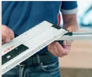
Die für den Winkelanschlag benötigte Gradzahl wird einfach über die große und gut lesbare Skala eingestellt und über die Arretierung fixiert.
