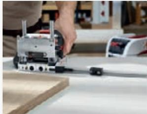
Das patentierte Anschlag-system mit gefederten Anschlagstiften in der Grundplatte wurde einfach für den neuen Seitenanschlag SA 320 adaptiert.
