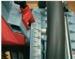
Gut ablesbare Skala. Standard Neigungswinkel können mittels Rastfunktion schnell und einfach eingestellt werden.
