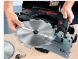
Mit einer Einstellung kann das Sägeblatt und die Pendelhaube arretiert werden. Praktisch, denn die Einschaltsperr ist damit ebenfalls aktiviert.
