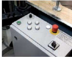
Übersichtlich und klar angeordnet – die Bedienungselemente der ZAF 250 Vario für Automatik- oder Handbetrieb.
