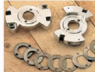
Die Breitereinstellung des Verstellnuters erfolgt durch Kombination unterschiedlicher Distanzringe.
