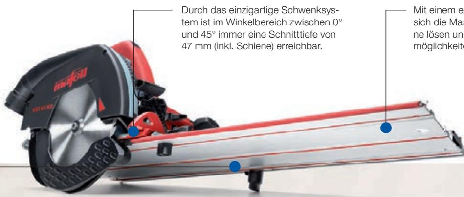
Durch das einzigartige Schwenksystem ist im Winkelbereich zwischen 0° und 45° immer eine Schnitttiefe von 47 mm (inkl. Schiene) erreichbar.
