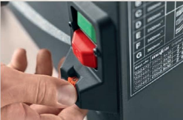
Die stufenlose Drehzahleinstellung für individuelle Anforderungen und Einsatzzwecke ist an der Frontplatte ideal platziert. So lässt sich die Drehzahl bequem auf unterschiedliche Materialien und Anwendungen einstellen.
