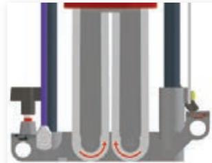
Zwei gegenläufige Spezialfräsketten sorgen für ausrissfreies Arbeiten und optimalen Spänefluss.
