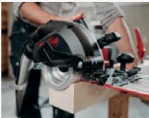
Die geballte Power und hohe Durchzugskraft der NFU 50 lassen Fräsungen mit einer Breite von 60 mm und einer Tiefe von 50 mm zu.
