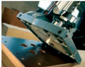
Für Serienbohrungen und Lochbilder kann die Einlegeplatte gegen eine Kopiereinlage getauscht werden. Ideal für das Arbeiten mit Bohrschablonen.
