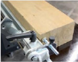
Das 3 Meter lange Anschlagprofil mit mm-Skala sowie der Längenanschlag ermöglichen präzises Positionieren der Werkstücke.
