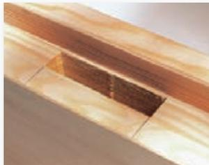
Schlitzlängen von 78 mm und Schlitzbreiten von 16 mm sind mit einmaligem Einstich möglich. Auch breitere oder längere Schlitzlöcher werden millimetergenau ausgearbeitet – durch einfaches Nachsetzen des SKS 130.
