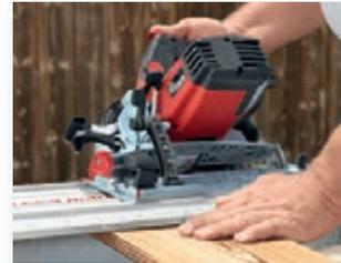
Dank großdimensionierter Winkelskala lassen sich Gehrungsschnitte passgenau umsetzen. Wie hier am Beispiel einer Fassadenschalung.
