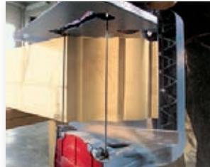
Dank hohem Drehmoment sind für die Z 5 Ec Einsätze in Massivholz mit Schnitttiefen von 305 mm kein Problem.
