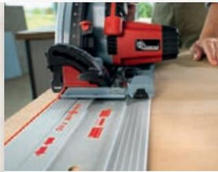
Zwei steckbare Haftstränge an der Schienenunterseite bewirken eine absolut rutschsichere und materialschonende Auflage.
