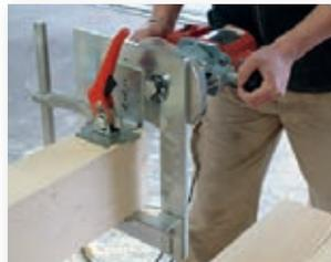
Schnelligkeit: 8 bis 18 Verbindungen pro Stunde (Zapfen + Einschnitt)
