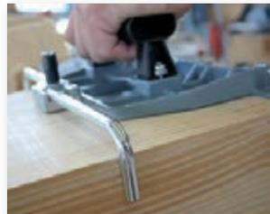
Der Anschlagbügel kann für Serienarbeiten stufenlos eingestellt werden.
