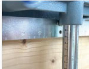
Der vertikale Randabstand kann über eine Skala exakt eingestellt werden.
