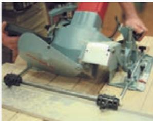
Die ZK 115 Ec mit der Führungsschiene.
