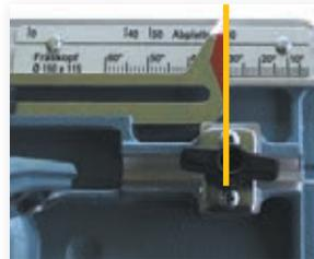
Einfach die Maschine auf Anriss-Kerveneck positionieren.
