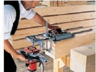
Hochpräzise Fräsungen für hochwertige Knotenblechverbindungen im Ingenieurholzbau.
