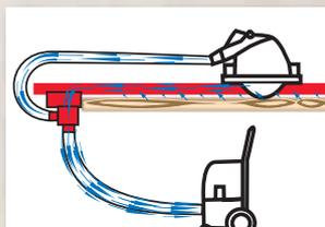
Ansaugen zum Schneiden von Platten, Türen usw. Die F-AFU 130 wird über den Doppeladapter von unten angesaugt und ist fest mit der 1,3 m langen Führungsschiene verbunden.
