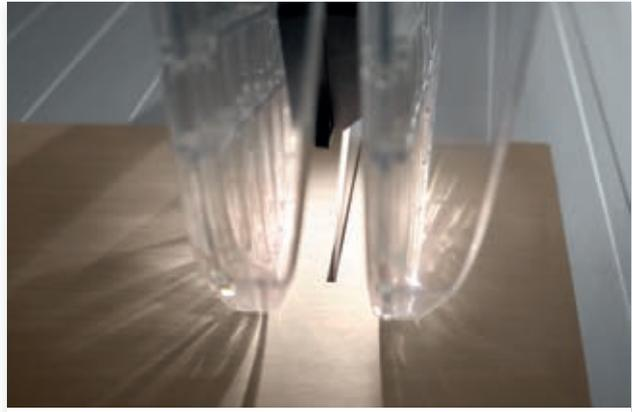
Das sensorgesteuerte Arbeitslicht sorgt für beste Sicht auf den Schnitt. Die teilweise transparente Schutzhaube deckt das Sägeblatt komplett ab und sorgt damit für mehr Sicherheit.
