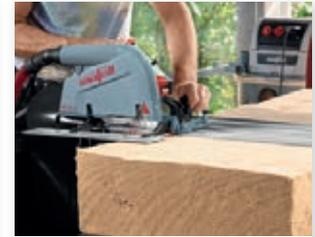
Mit der DSS 300 cc lassen sich auch flexible Materialien, zum Beispiel für die Dämmung im Gefach, schnell und präzise bearbeiten.
