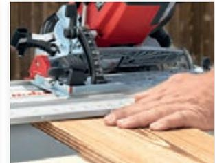
Dank großdimensionierter Winkelskala lassen sich Geh-rungsschnitte passgenau umsetzen. Wie hier am Beispiel einer Fassadenschalung.
