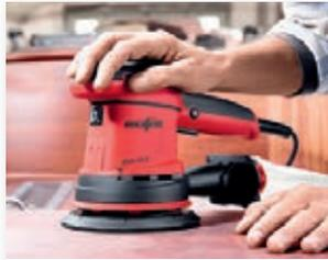
Für Feinschliff oder einen Lackzwischen-schliff eignet sich besonders der EVA 150 E/3 mit seinem Schwinghub von 3 mm.
