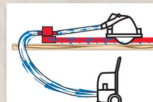
Ansaugen auf Flächen. Durch einfaches Aufstecken des Adapters F-AFO auf eine bestehende Führungsschiene F, kann von oben angesaugt werden.
