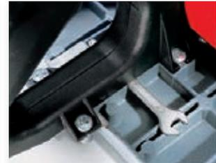
Das Werkzeug für den Messerwechsel befindet sich direkt an der Maschine.
