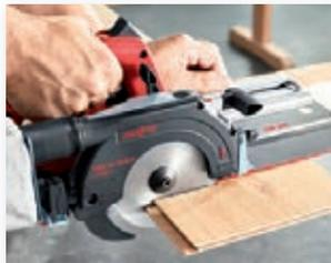
Durch die feste Verbindung der Handkreissäge mit der KSS-Kappschiene ergibt sich eine hochfunktionelle Einhand-Kappschiensäge.
