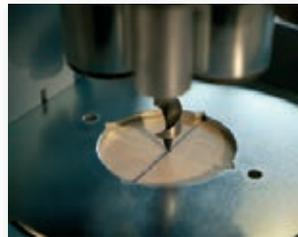
Mit den Anrisskerben kann der Bohrer äußerst präzise angesetzt werden. Auch in geschwenkter Arbeitsposition bildet die Bohrerspitze immer den Schwenkpunkt.
