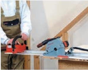
Durch den motorischen Sägevorschub und die Einmann-Bedienung lassen sich Plattenwerkstoffe schnell und einfach bearbeiten.
