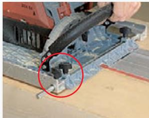
Perfekter Höhenausgleich. Durch den Gleiter aus Pertinax wird die Materialstärke der Führungsschiene ausgeglichen.
