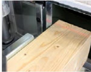
Die Lasertechnik ermöglicht Ihnen, das Werkstück nach Anriss zu positionieren.
