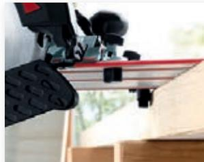
Der fixe und der einstellbare Anschlag an der Unterseite der Schiene sorgen dafür, dass das System für Winkelschnitte von  $+50^\circ$  bis  $-60^\circ$  eingesetzt werden kann.
