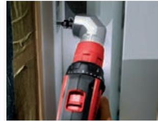
Mit dem cleveren Winkelvorsatz lassen sich Schrauben auch bei beengten Platzverhältnissen mühelos eindrehen.
