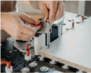
Um die Auflage der Platte auf den Kugelrollen des Bearbeitungstisches BAT zu unterstützen, kann optional der Niederhalter auf die exakte Plattenhöhe eingestellt werden.
