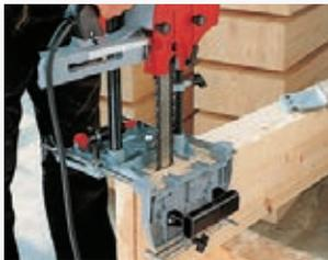
Universell einsetzbar für Stützfüße, Integralverbinder und Knotenbleche.
