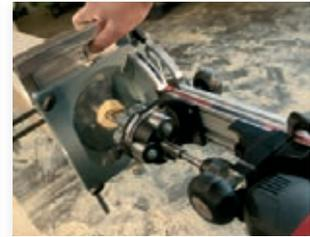
Der Parallelanschlag z.B. für Stirnholzbohrungen, ergibt in Kombination mit dem Seitenanschlag das ideale Paar für Serienfertigungen.
