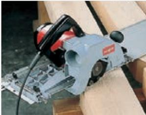
Führungseinrichtung mit Winkelanschlag und Adapter als Sonderzubehör.
